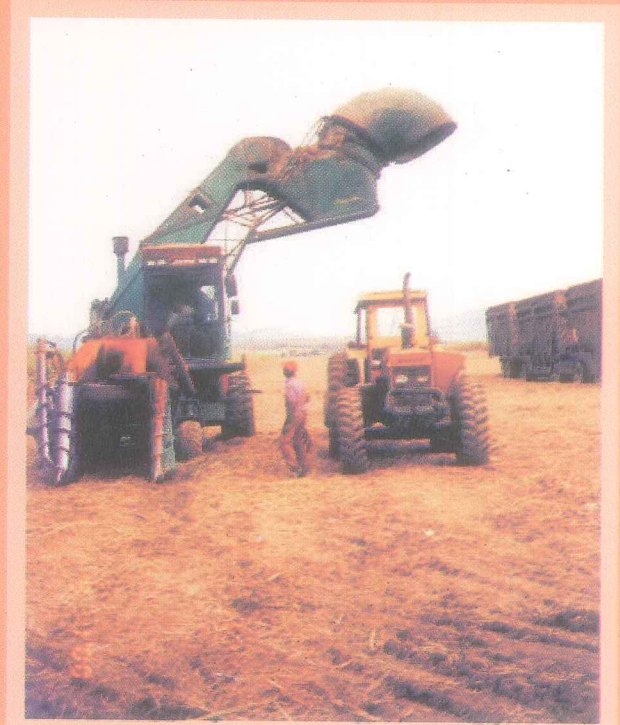
Uma colheitadeira de cana, máquina capaz de substituir o trabalho de cem homens no corte, é um exemplo de fator de modernização agrícola, produzido pela indústria a montante da agricultura. Em Quissamã, porém, o seu uso é restrito devido às ondulações do terreno, que impedem sua utilização em diversas quadras de plantio das fazendas.
